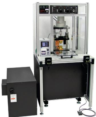
Soudage par simple décharge pour le scellage des têtes hermétiques circulaires et rectangulaires
