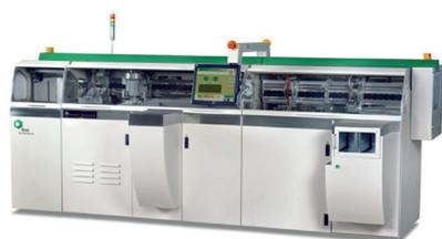
Sciage et triage en une seule station avec un processus sans tape pour substrats jusqu'à 100 x 300 mm
