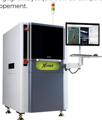
Technologie adaptée à l'analyse Pre et Post brasage et analyse 100% 3D des assemblages CMS
