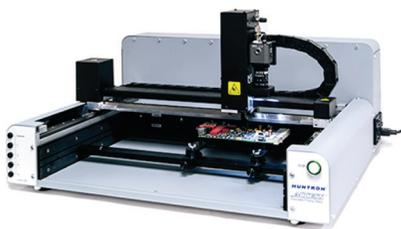
Taille maximale du circuit imprimé : 49,3 cm x 35,6 cm (19,4 po x 14 po) ACCESS 2 : 56 cm x 58 cm (22 po x 23 po)
