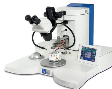
Wedge et Ball bonding et bump bonding (Ruban en option)
