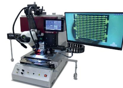
Déplacement en Z suivant la technologie «True Vertical» sur 125mm
