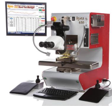
Motorisation des 4 axes avec une précision de 0,1µm et 0,1°
