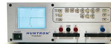
Mesure et comparaison (V/I) jusqu'à 40 « pins » en simultané
