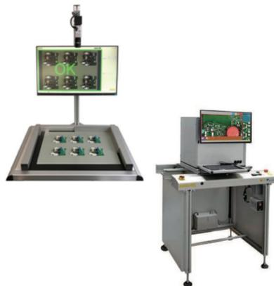
Les tests typiques sont : l'assemblage mécanique, la présence, l'emplacement et l'orientation des composants, des étiquettes, des fixations, la lecture des codes à barres et des codes Datamatrix et l'inspection avant ou après Vague des composants traversants
