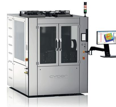
Chambre de chauffage par convection pour profilométrie à haute résolution avec chaleur statique. Taille de l'échantillon : jusqu'à 300 mm et température de 300 °C à -30 °C avec refroidissement à l'azote
