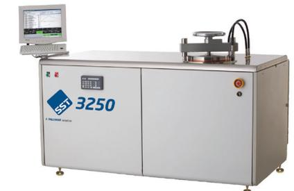
Chambre pression 1 x 10<sup>-7</sup> mbar jusqu'à 0,8 bar
