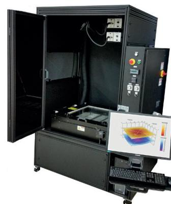
Cycle de refusion typique de 20 minutes, avec un chauffage à +1°C/s et un refroidissement à -1°C/s
