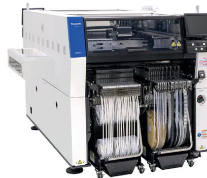
Vitesse de placement jusqu'à 104 000 CPH avec les têtes FC16\_2
