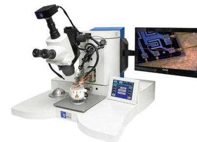
Wedge et Ball bonding et bump bonding (Ruban en option)
