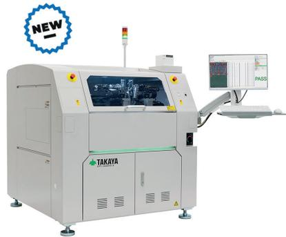
Test double-face simultané : Jusqu'à 6 sondes sur le dessus et 4 en dessous
