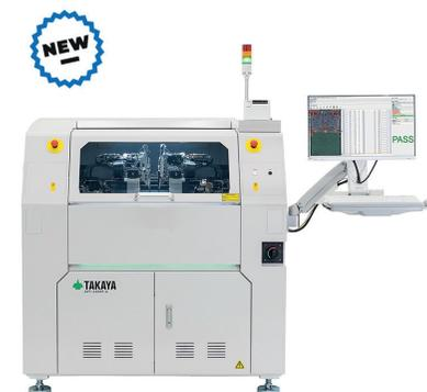
Système 4 têtes, 6 sondes mobiles : Accès à des points complexes et détection optimisée
