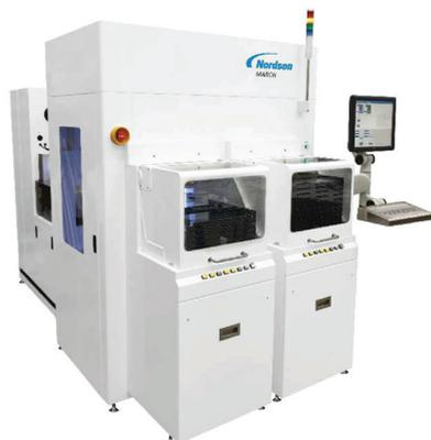
La conception et l'architecture de commande symétriques de la chambre F3 brevetées permettent des temps de cycle de plasma courts avec un faible surcoût et une excellente uniformité dans le process
