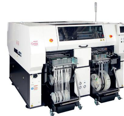
Polyvalence des composants : compatible avec des tailles de composants allant de 0402mm (01005inch) à 150 \_ 25mm
