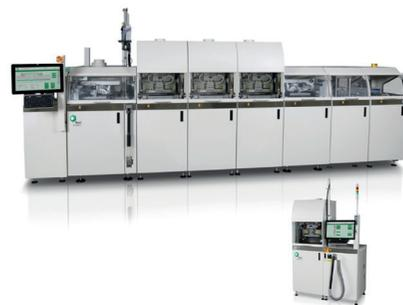
La MMS-LM, manuelle pour la production ou le nettoyage de moules hors ligne
