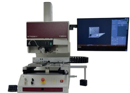
Déplacement automatisé en Z suivant la technologie «True Vertical» sur 120mm
