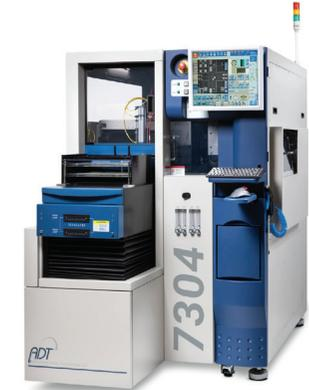
Découpe d'applications autres que les wafers avec cadres de 225 x 300 mm pour multi-bandes, verres et céramiques jusqu'à 10 mm d'épaisseur
