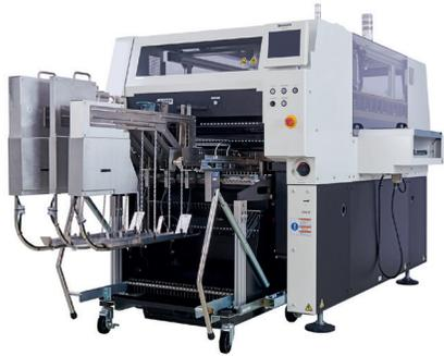
Insertion rapide : jusqu'à 0,65 s par composant avec une structure à deux têtes pour une productivité accrue
