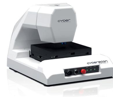
Options pour capteurs : confocal chromatique, interféromètre, interféromètre 3D à lumière blanche, microscope confocal, réflectomètre, caméra haute résolution
