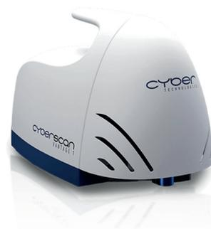
linear y-axis 50 mm avec résolution 50 nm
